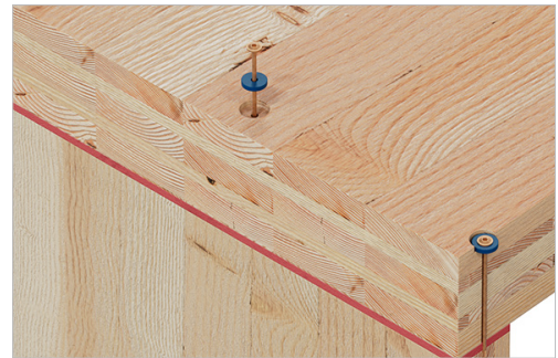
SWW-skrue brukt i en CLT gulv-til-vegg-forbindelse.
